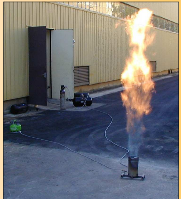
Torchage d'un réservoir GPL
