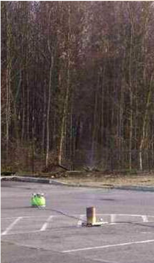
Torchage d'un réservoir GNV
